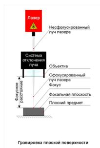
Рассмотрим подробнее лазерный метод гравировки, как более распространенный и универсальный. Часто из-за отсутствия явно выраженной глубины лазерной гравировки этот процесс называют лазерной маркировкой.
